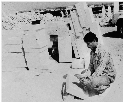
Fig. 8 - Pierres sciées en séries normalisées pour le bâtiment (şârî). Au premier plan, le parement d'une d'elles est en cours de bouchardage (bûchârâtâ).
