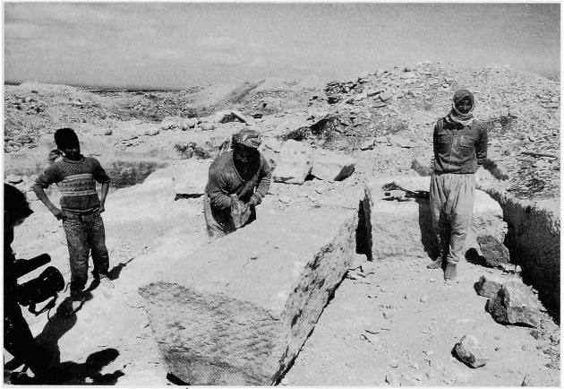
Fig. 22 - Equarrissement d'un bloc brut d'extraction à l'aide du tranchant à méplat du châqîf .
