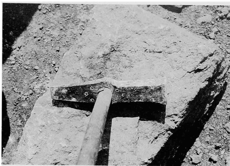
Fig. 32 - Tête-polka ( dabbûrâ ) estampillé de rosettes constituant la marque de fabrique du forgeron.
