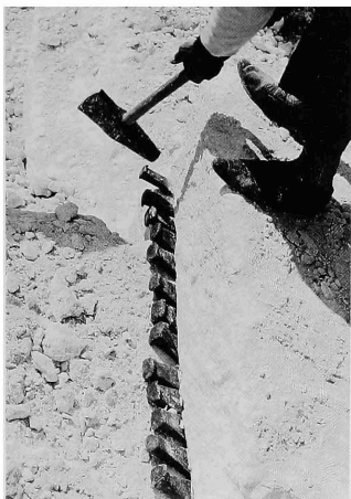
Fig. 19 - Série de treize coins placés à la base d'un bloc de 1,25 m de long. Ils sont forcés à l'aide du côté masse du châtif.
