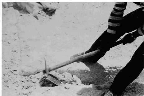
Fig. 29 - Curette de carrier (mijrafé) utilisée dans la carrière de Résafa.
