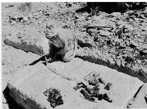
Fig. 20 - Finition soignée des encoignures supérieures au mortaisoir en vue d'obtenir une rupture verticale des blocs à l'aide de coins. Le grand monolithe initial a été séparé de la roche par une tranchée creusée au pic d'extraction.
