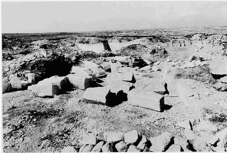
Fig. 3 - Vue générale vers le nord d'une partie des carrières traditionnelles d'Aramel. Au premier plan sont entreposés des pierres à bâtir et derrière, des gros blocs destinés à la production de stèles funéraires après débitage dans des scieries.
