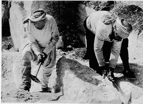
Fig. 17 - Carrier creusant, avec un pied dans la tranchée d'extraction (à droite). À gauche, un second ouvrier creuse l'encoignure à la base du bloc.
